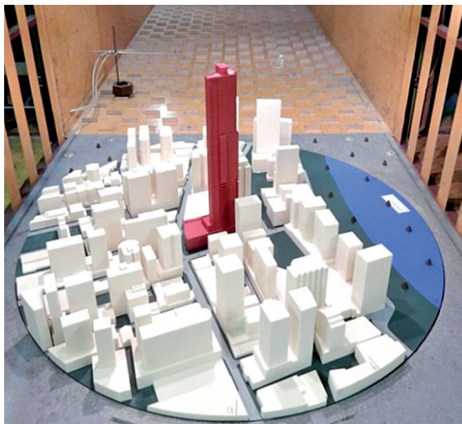
Modelo de um prédio submetido ao ensaio de Túnel de Vento
