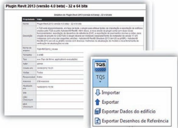
Obs: Após instalar o Plugin Revit-TQS, ele estará disponível no menu Add-Ins do Revit, conforme a figura abaixo:
