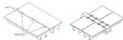
Ligações de lajes PI (pré-moldadas) entre si e com as vigas (pré-moldadas) de apoio.
