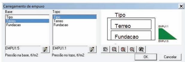
As forças de empuxo podem pertencer aos casos padrão de empuxo ou a casos adicionais, dependendo da natureza (permanente ou acidental) e da forma como devem ser combinadas no projeto. A aplicação é nos pilares em contato com a face de aplicação, com separação por área de influência de maneira semelhante ao carregamento de vento. As forças efetivamente lançadas são mostradas no relatório de geração do modelo de pórtico espacial.
