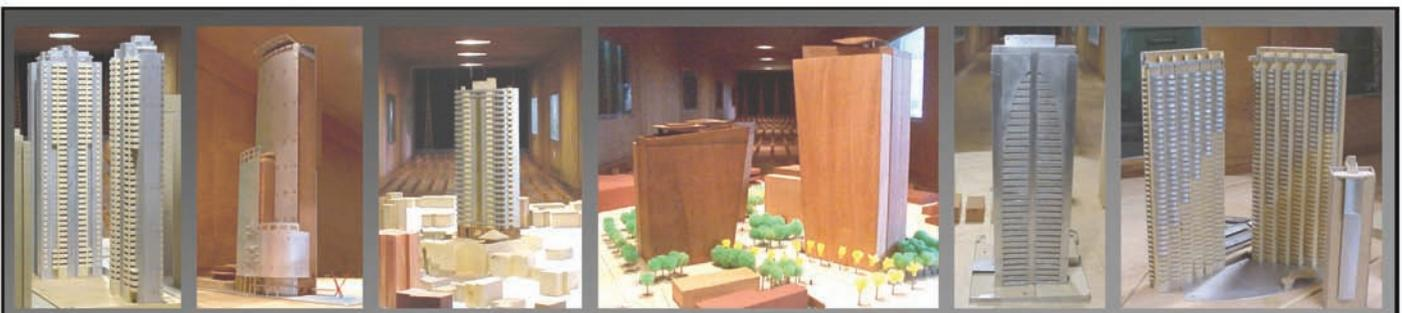
**Ensaio em Túnel de Vento**
