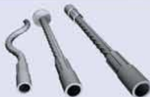
Continuidade de Armaduras Inserto metálico com ancoragem incorporada utilizado na continuidade de armaduras de vigas e pilares para posterior concretagem e no içamento de peças pré-moldadas.
