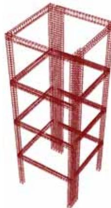
Perceba também que, com a discretização adotada, é definida uma rigidez para cada trecho de pilar e viga. Cada barra tem um EI diferente!
